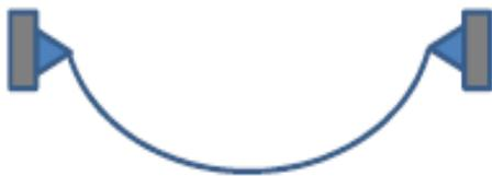
$$a = \frac{T_0}{p} = \text{parámetro de la catenaria (m)}$$
