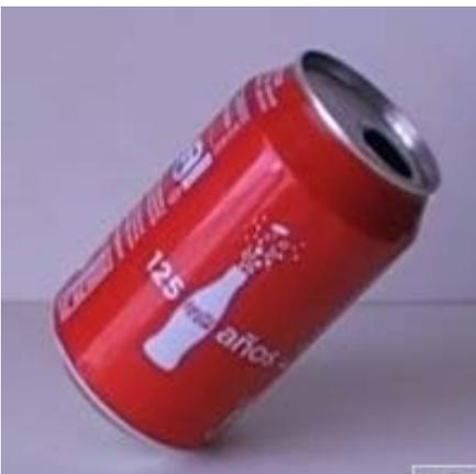
**Explicación:** colocar el agua o la arena en la parte inferior de la lata, sería equivalente a mantener el centro de masas prácticamente pegado a la mesa puesto que la lata tiene un peso mucho menor. De esta forma, esta no volcaría a pesar de estar en esa posición tan inestable.
